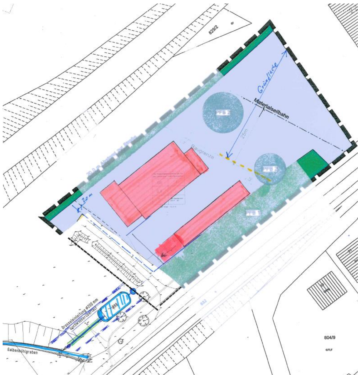
Abbildung 1: Planskizze zum geplanten Bauhof mit südwestlich anschließender Entwässerung (IB Karle, Januar 2022)
